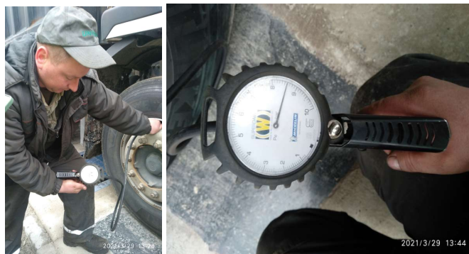
Рисунок 2 – Визначення тиску повітря у кожному колесі Figure 2 – Determination of air pressure in each wheel
