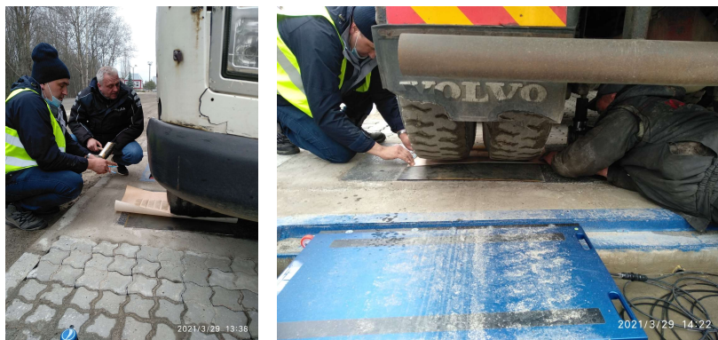
Рисунок 3 – Визначення форми відбитку колеса Figure 3 – Designation of the shape of the wheel's impact
